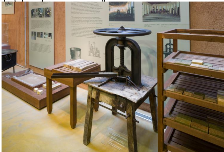
Εικόνα 1. Χειροκίνητη Πρέσα σφραγίσματος σαπουνιού. Μυτιλήνη, 20ός αι. Έκθεμα του Μουσείου Ελιάς και Ελληνικού Λαδιού στη Σπάρτη
