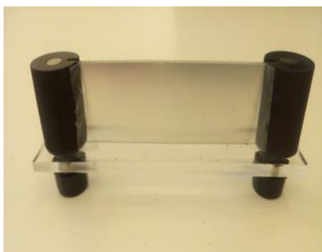
Μαγνητικό Κάτοπτρο Επίπεδο που γίνεται κοίλο και κυρτό
