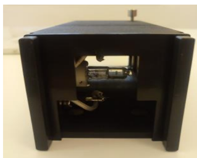
Πηγή φωτός μαγνητική με διαφράγματα Παραγωγή παράλληλης δέσμης λευκού φωτός
