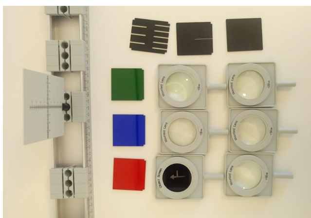
Διαφράγματα της δέσμης Φακοί Οπτικής Τράπεζας (-150, +50, +100, +150, +200) Βάσεις στήριξης Χρωματιστά Φίλτρα
